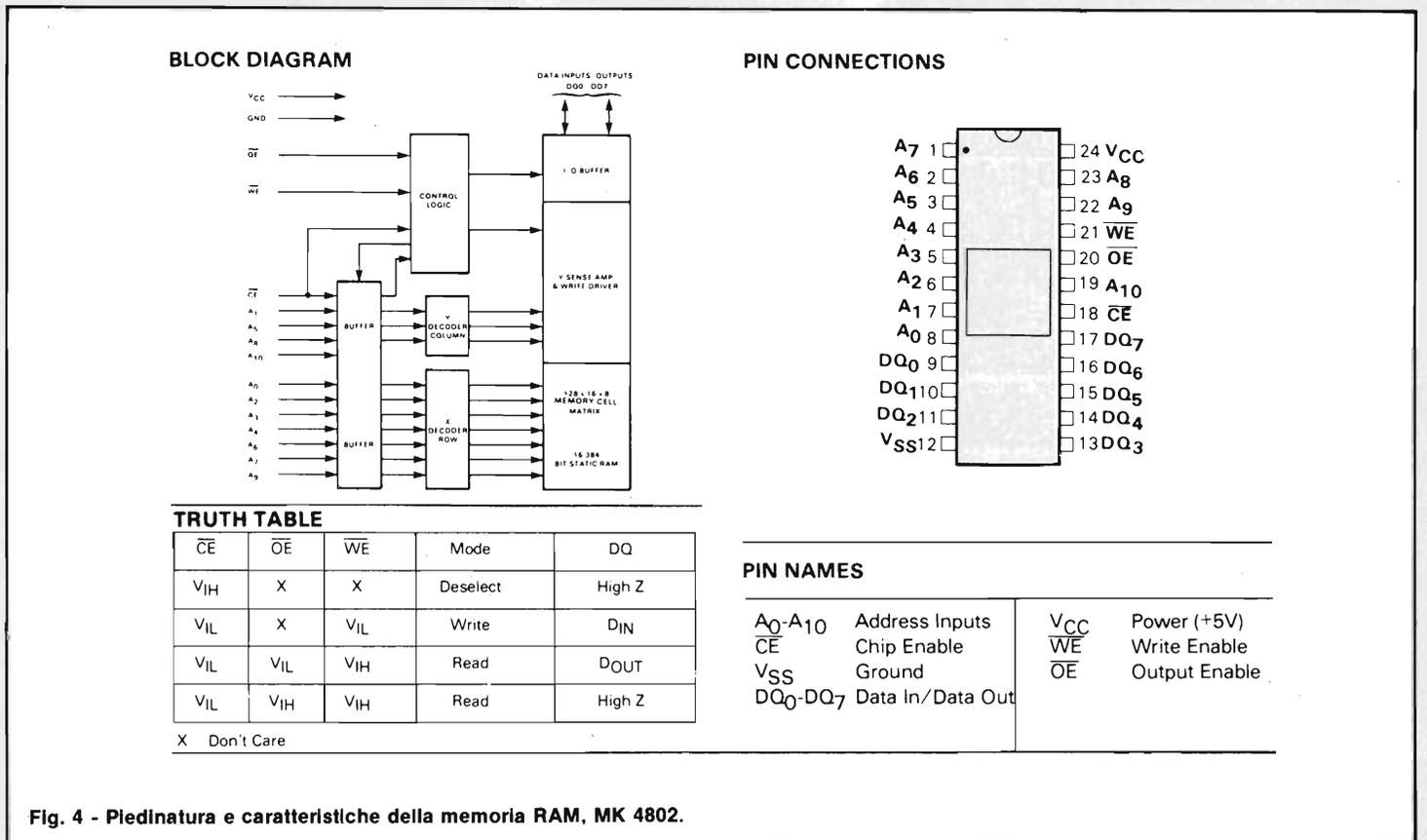
Fig. 4 - Piedinatura e caratteristiche della memoria RAM, MK 4802.
