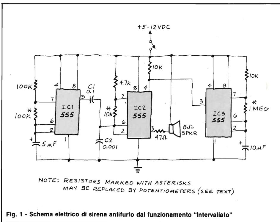
Fig. 1 - Schema elettrico di sirena antifurto dal funzionamento "Intervallato"
