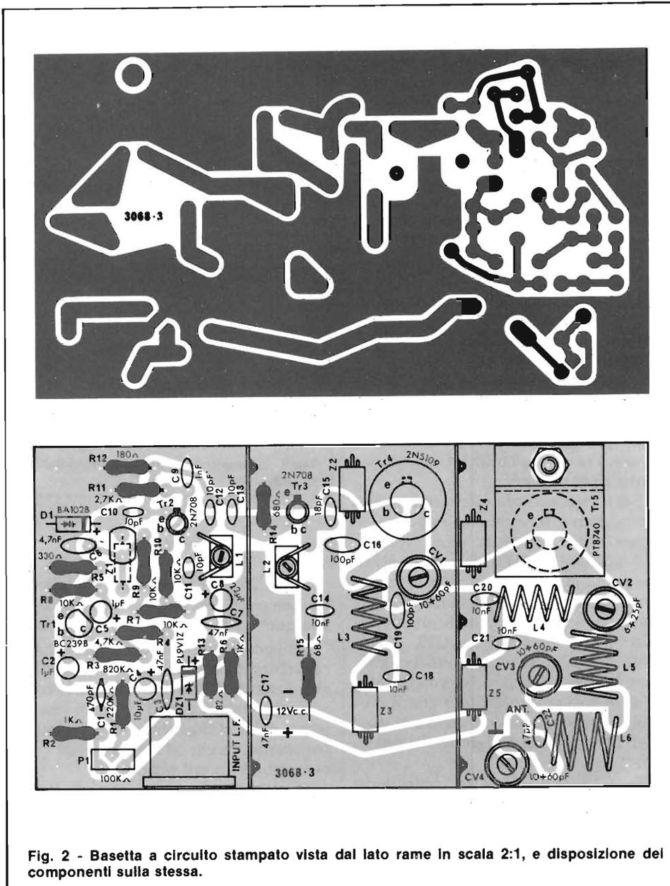
Fig. 2 - Basetta a circuito stampato vista dal lato rame in scala 2:1, e disposizione dei componenti sulla stessa.
