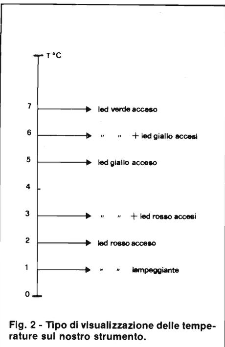
Fig. 2 - Tipo di visualizzazione delle temperature sul nostro strumento.
