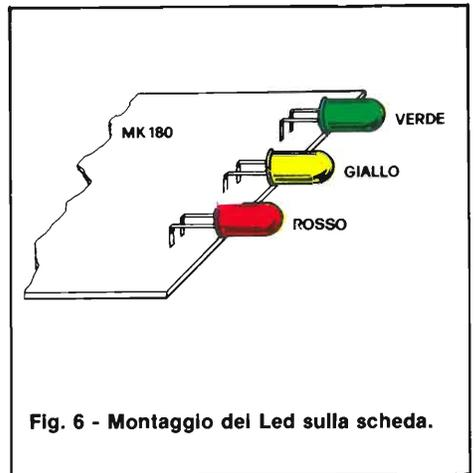
Fig. 6 - Montaggio dei Led sulla scheda.
