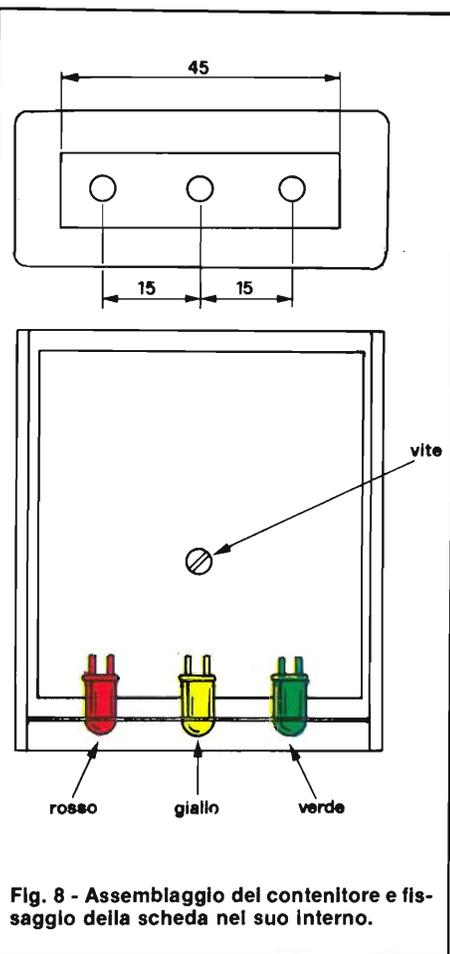
Fig. 8 - Assemblaggio del contenitore e fissaggio della scheda nel suo interno.
