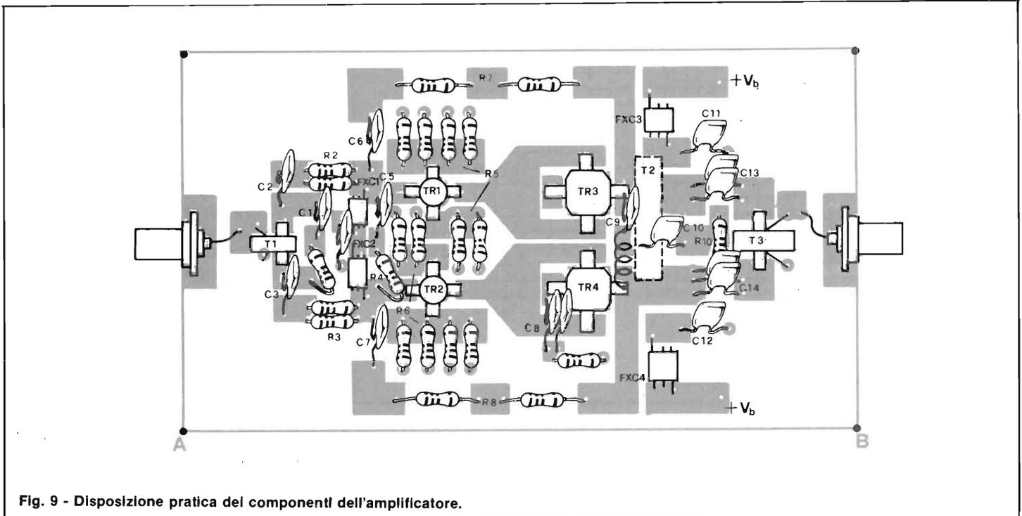
Fig. 9 - Disposizione pratica dei componenti dell'amplificatore.
