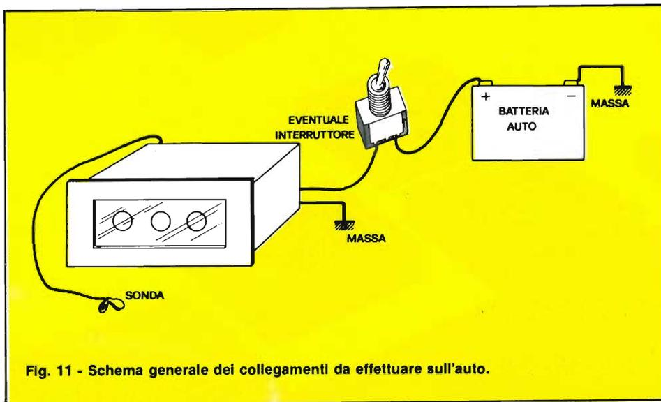
Fig. 11 - Schema generale dei collegamenti da effettuare sull'auto.
