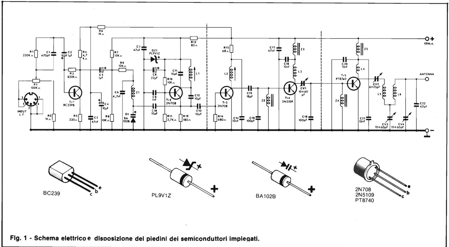
Fig. 1 - Schema elettrico e disposizione dei piedini dei semiconduttori impiegati.
