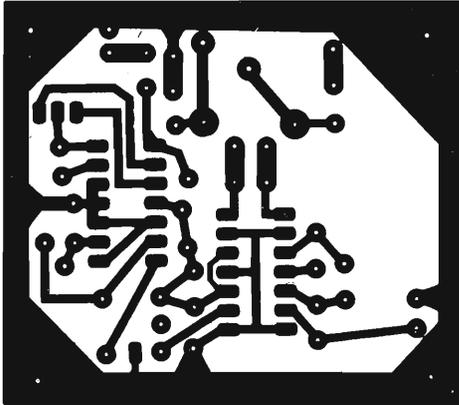
Fig. 2 - Circuito stampato della basetta principale del "Gipsy". Il modulo, che misura 60 x 55 mm, deve essere realizzato su vetronite; sia la trascrizione delle piste che la saldatura devono essere eseguite con precisione ed accuratissima, date le elevate frequenze in gioco.
