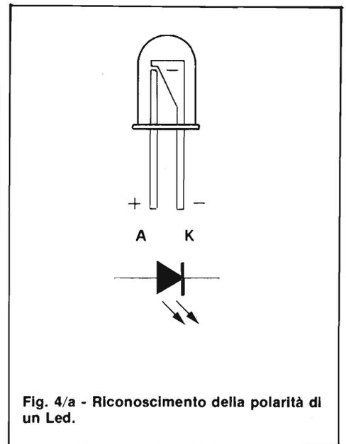
Fig. 4/a - Riconoscimento della polarità di un Led.
