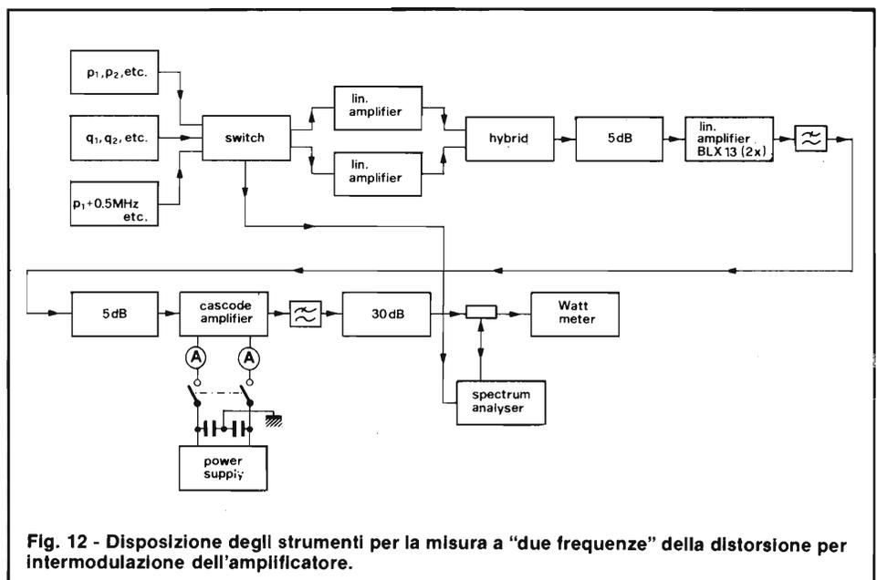
Fig. 12 - Disposizione degli strumenti per la misura a "due frequenze" della distorsione per intermodulazione dell'amplificatore.
