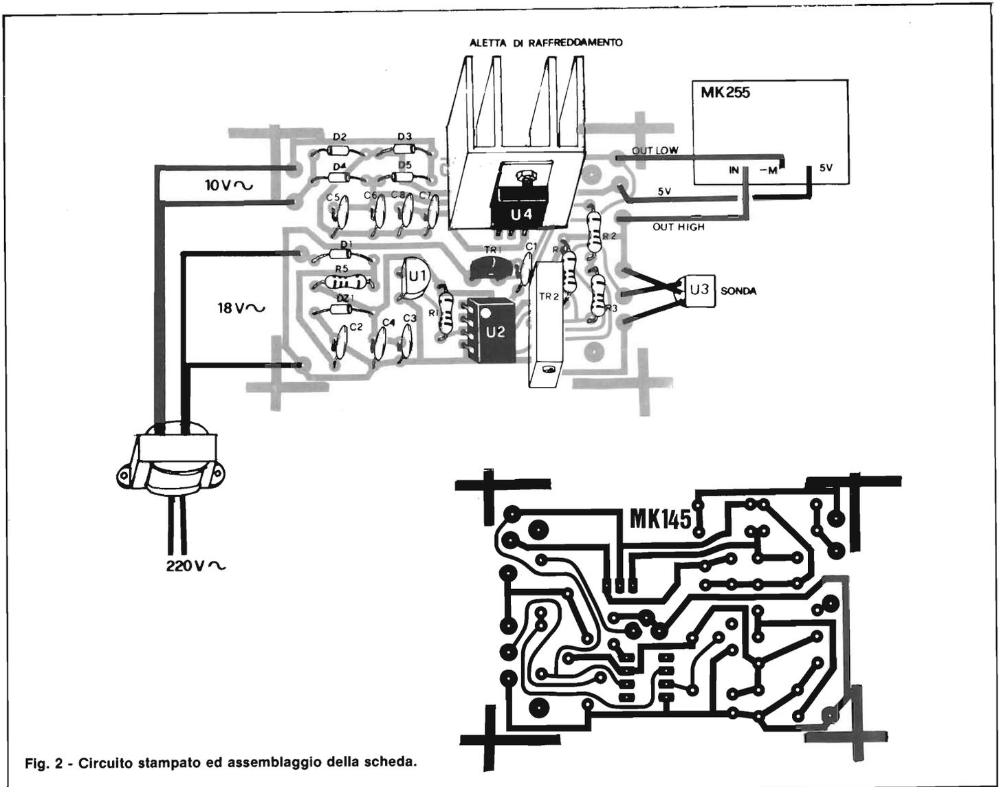
Fig. 2 - Circuito stampato ed assemblaggio della scheda.
