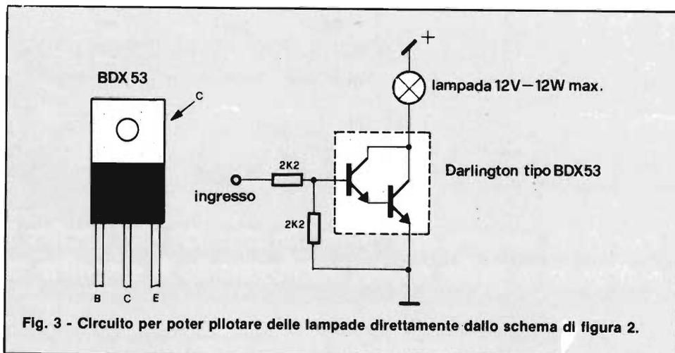
Fig. 3 - Circuito per poter pilotare delle lampade direttamente dallo schema di figura 2.
