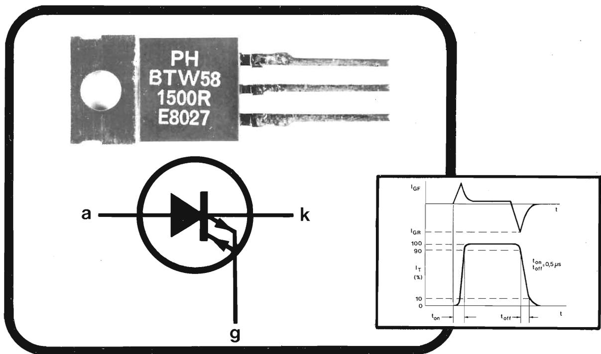
Del tiristore possiede infatti la caratteristica di entrare in conduzione all'atto dell'applicazione di un impulso positivo in gate. Del transistore possiede la caratteristica di cessare la conduzione all'atto dell'applicazione di un impulso negativo in gate. La struttura a quattro strati (pnpn) consente al BTW 58 di sopportare tensioni di apertura dell'ordine di 1500 V.
