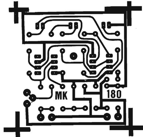
Fig. 5 - Schema di montaggio dell'MK 180 e basetta a circuito stampato in scala 1:1.
