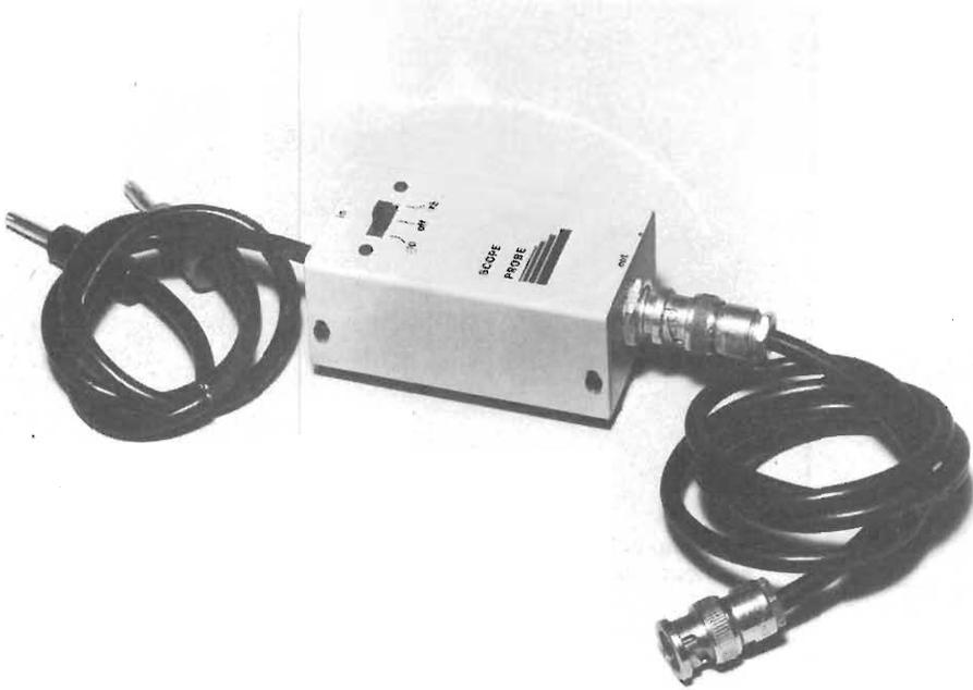
**Sonda a realizzazione ultimata. Il contenitore deve essere metallico per apportare un effetto schermante al circuito interno.**
