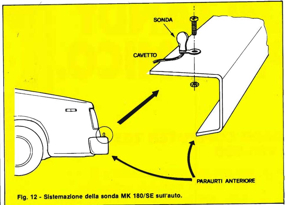
Fig. 12 - Sistemazione della sonda MK 180/SE sull'auto.
