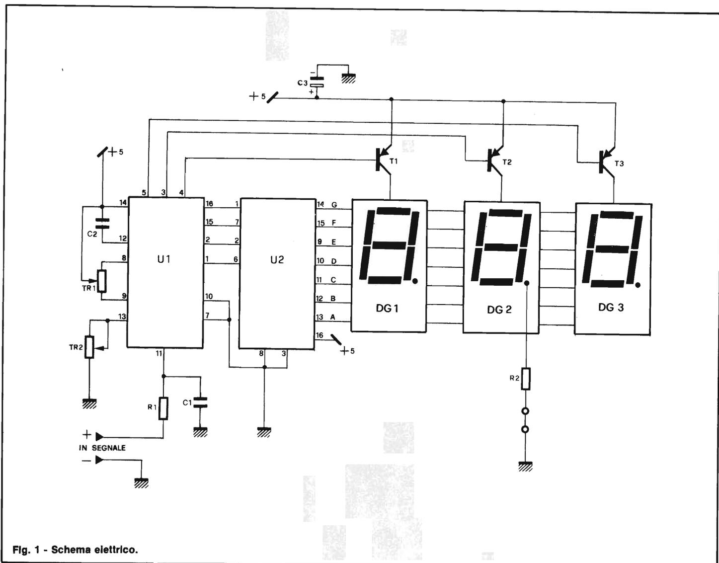
Fig. 1 - Schema elettrico.
