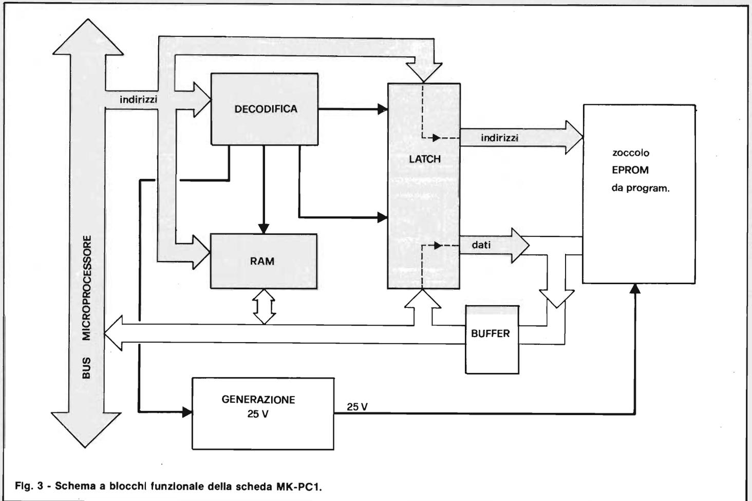
Fig. 3 - Schema a blocchi funzionale della scheda MK-PC1.
