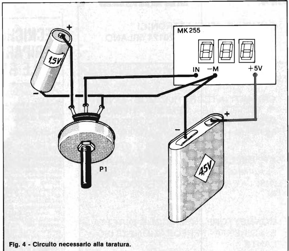
Fig. 4 - Circuito necessario alla taratura.
