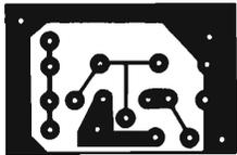
Fig. 3 - Per l'oscillatore locale del "Gipsy" abbiamo previsto una piccola basetta a se' stante. In figura si osservi la minuscola traccia del circuito stampato.
