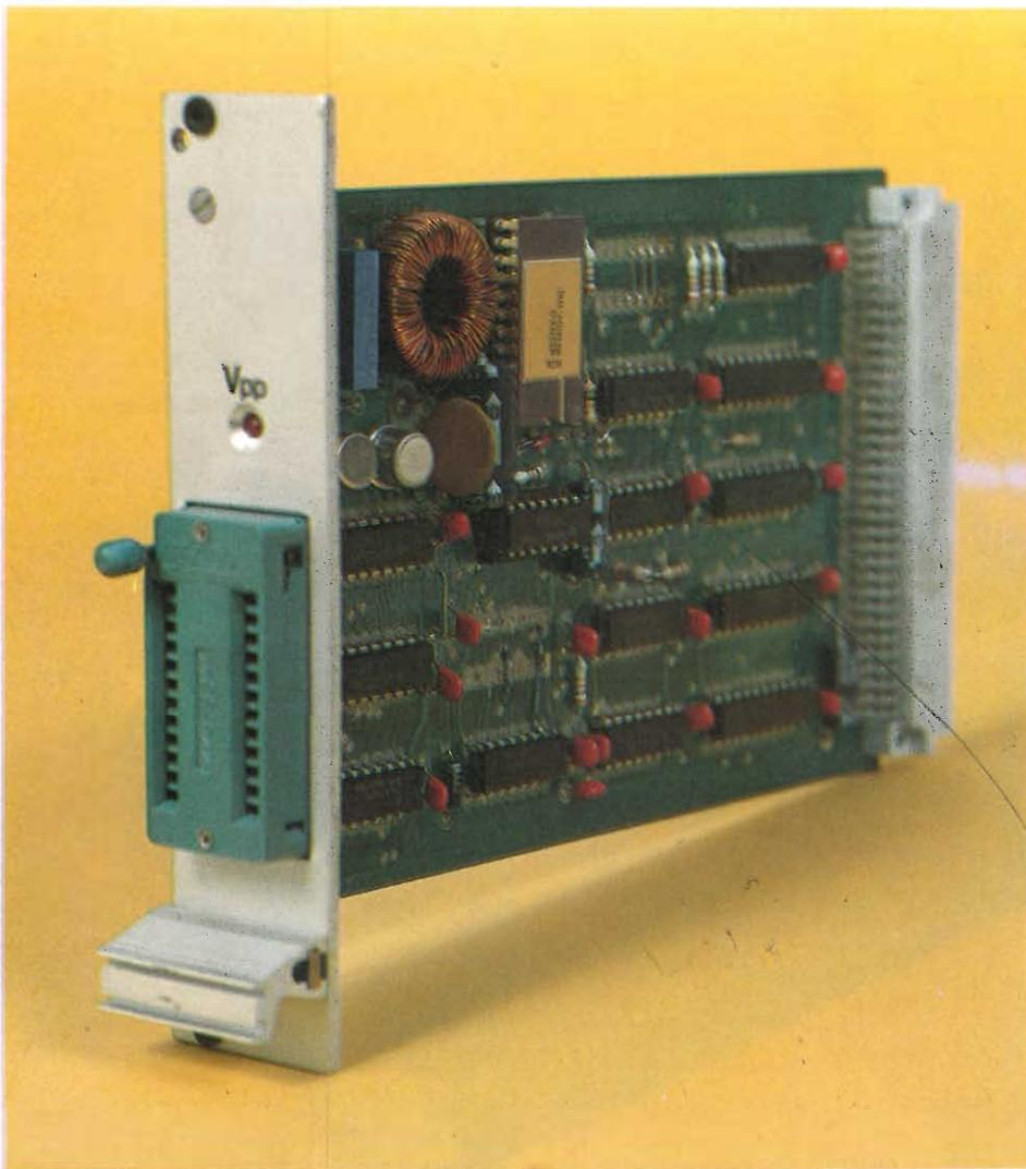
Particolare di montaggio della scheda MK-PC1 in cui si nota il frontalino di fissaggio dal quale fuoriesce lo zoccolo Tex-tool di inserimento per le Eprom.
