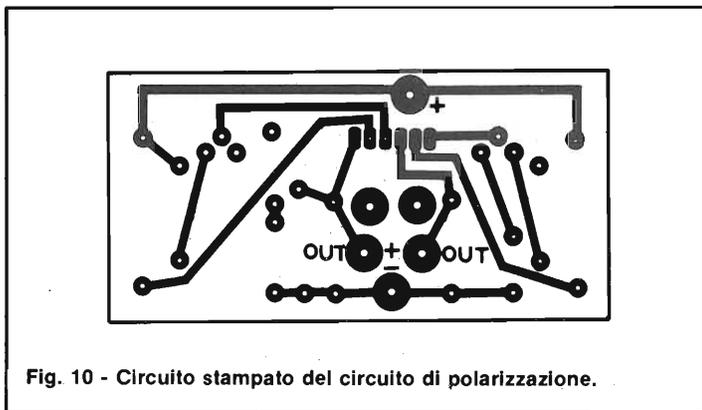
Fig. 10 - Circuito stampato del circuito di polarizzazione.
