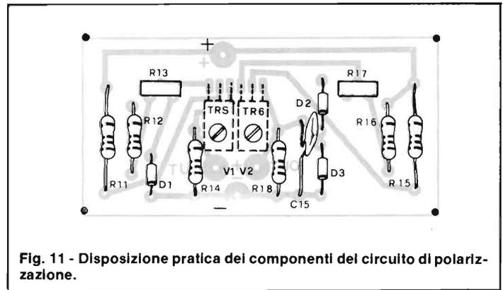
Fig. 11 - Disposizione pratica dei componenti del circuito di polarizzazione.
