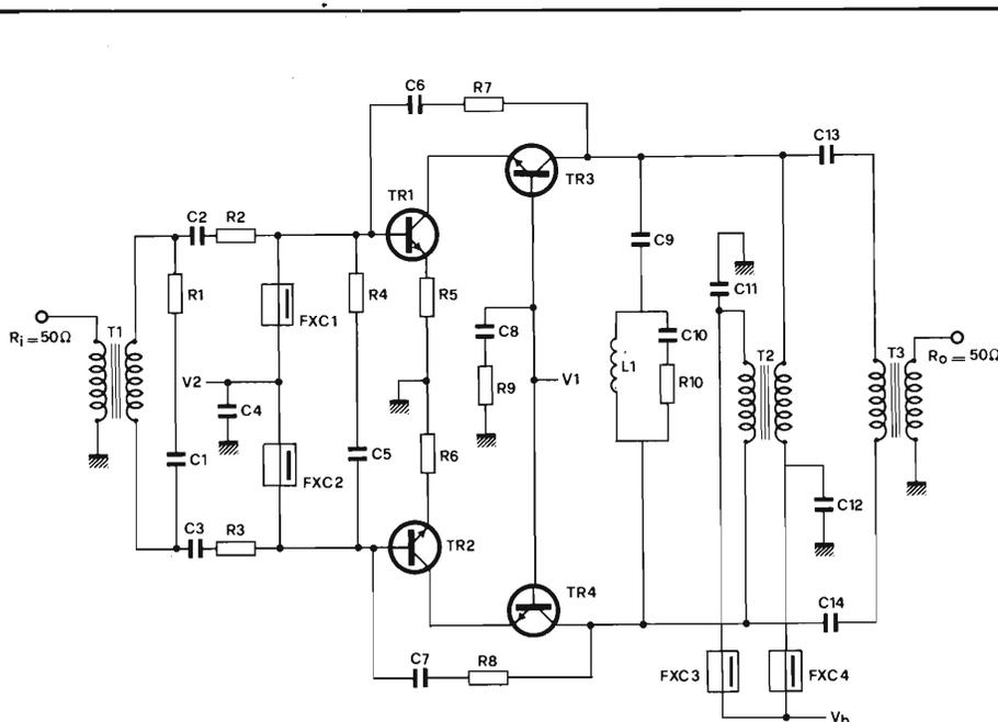
Fig. 6 - Circuito finale dell'amplificatore push-pull da 50 W.
