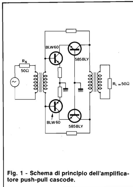
Fig. 1 - Schema di principio dell'amplificatore push-pull cascode.
