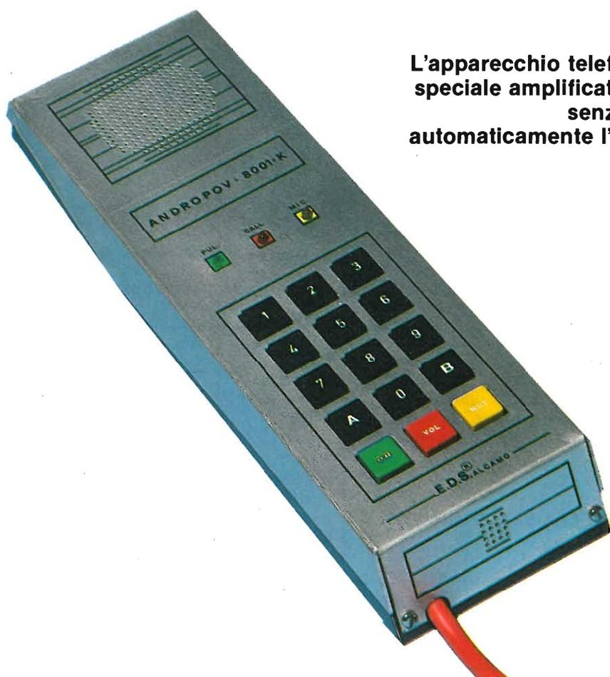
**L'apparecchio telefonico che presentiamo è munito di uno speciale amplificatore/preamplificatore a mani libere, cioè senza reggere il microtelefono, e di ripetere automaticamente l'ultimo numero formato fino al massimo di 18 cifre.**
