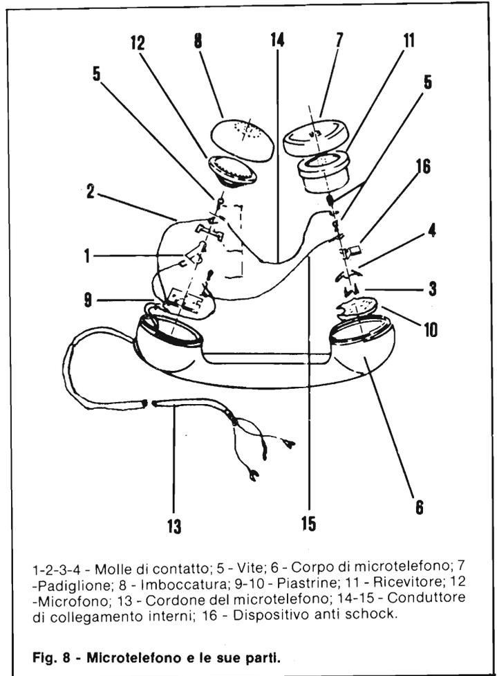
1-2-3-4 - Molle di contatto; 5 - Vite; 6 - Corpo di microtelefono; 7 - Padiglione; 8 - Imboccatura; 9-10 - Piastrine; 11 - Ricevitore; 12 - Microfono; 13 - Cordone del microtelefono; 14-15 - Conduttore di collegamento interni; 16 - Dispositivo anti shock.
