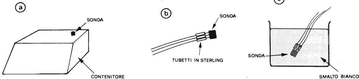
Fig. 5 - Disposizione ed impermeabilizzazione della sonda.
