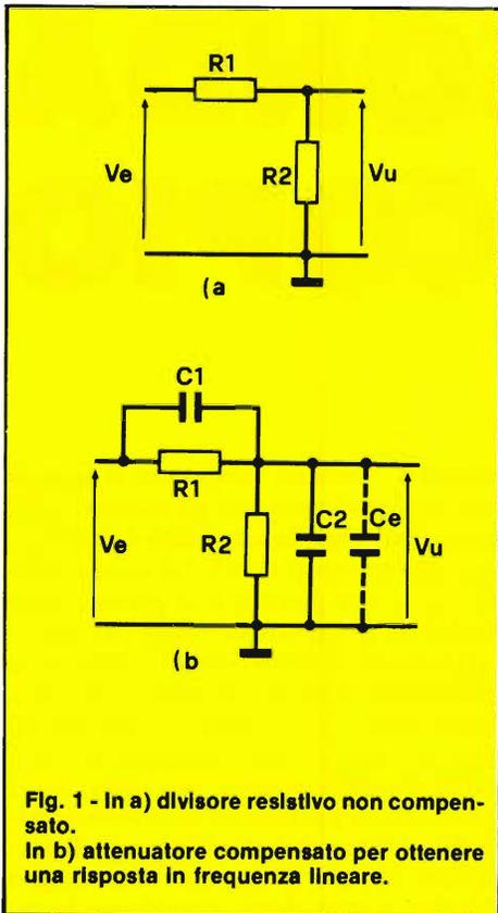
da attenuatori con rapporti di divisione ben precisi. Ogni attenuatore è quindi formato da un divider resistivo il cui circuito viene rappresentato in figura 1/a. Con tale configurazione però, la capacità  $C_e$  introdotta dal circuito d'ingresso dell'amplificatore e posta in parallelo ad  $R_2$ , influenza il trasferimento di  $V_e$  in
