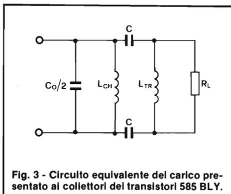
Fig. 3 - Circuito equivalente del carico presentato ai collettori dei transistori 585 BLY.
