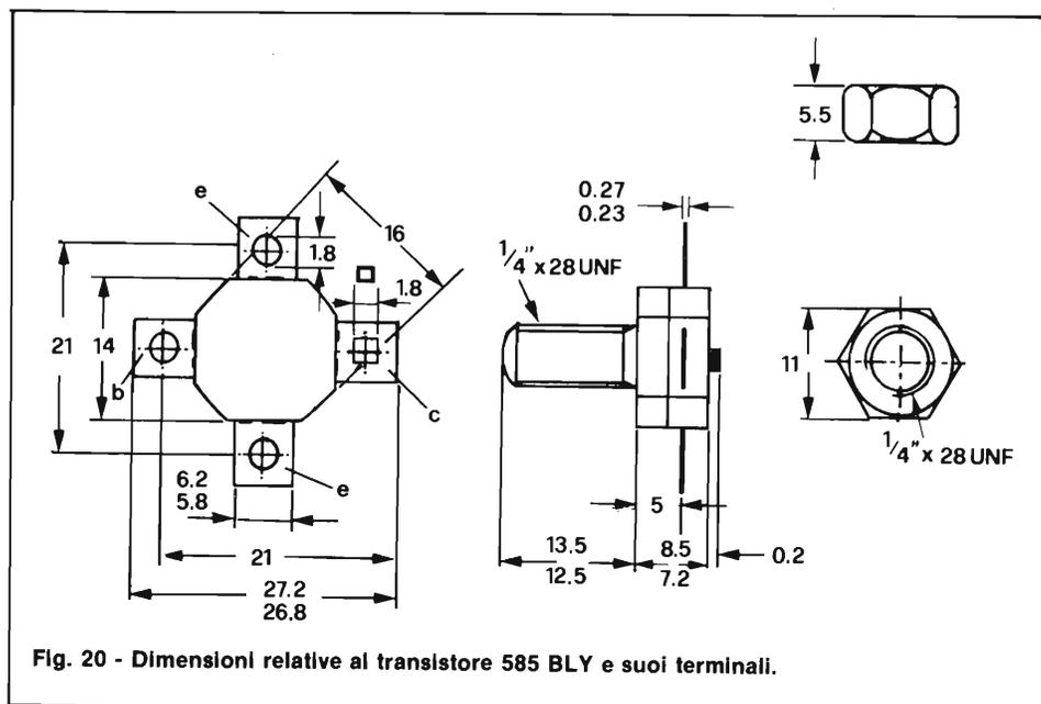
Fig. 20 - Dimensioni relative al transistore 585 BLY e suoi terminali.
