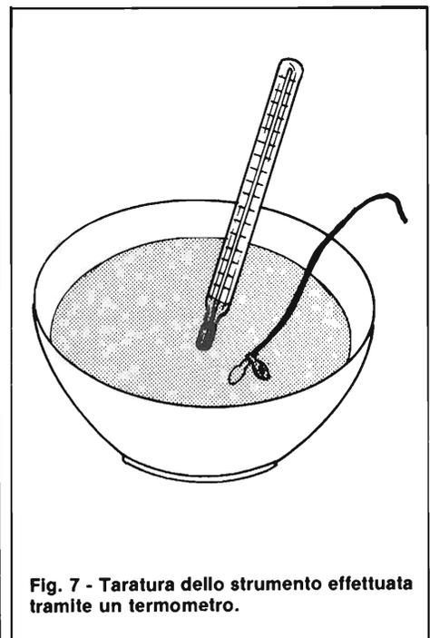
Fig. 7 - Taratura dello strumento effettuata tramite un termometro.
