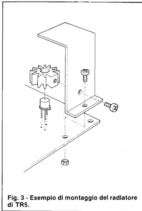
Fig. 3 - Esempio di montaggio del radiatore di TR5.
