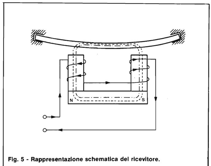
Fig. 5 - Rappresentazione schematica del ricevitore.
