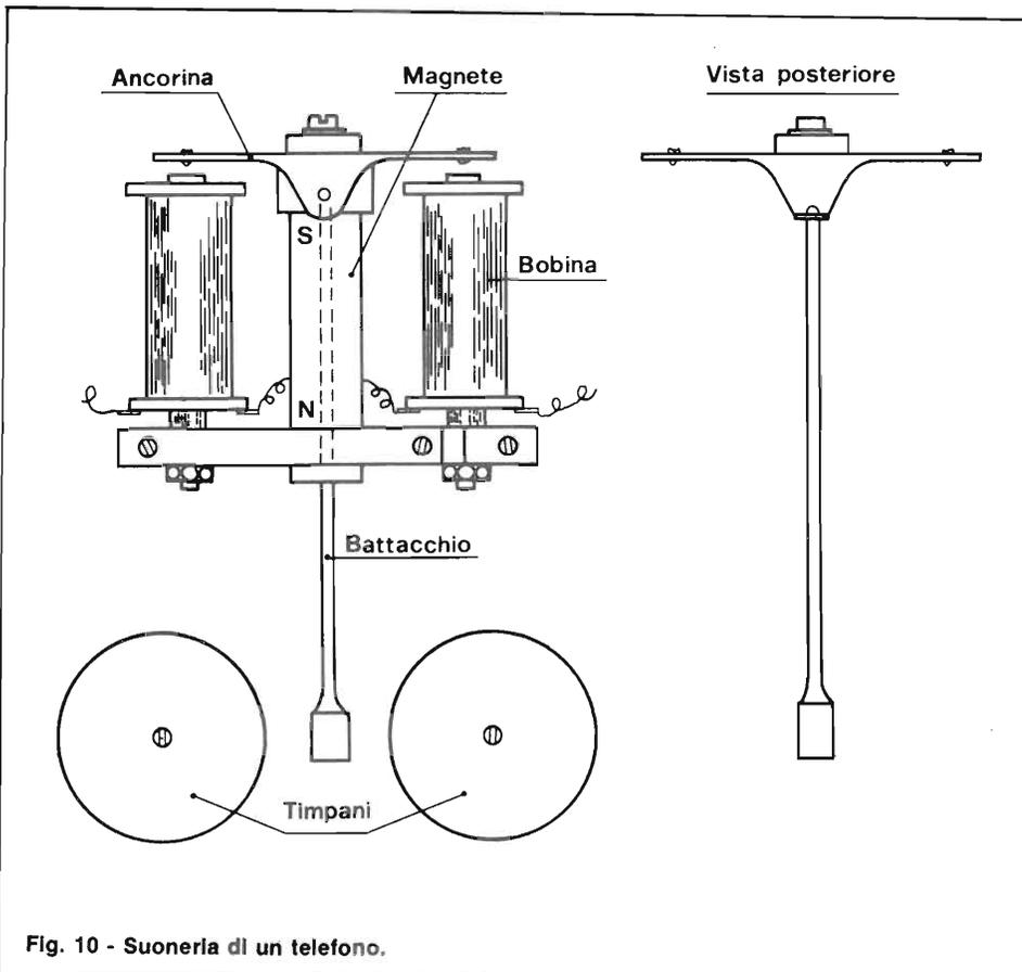
Fig. 10 - Suoneria di un telefono.
