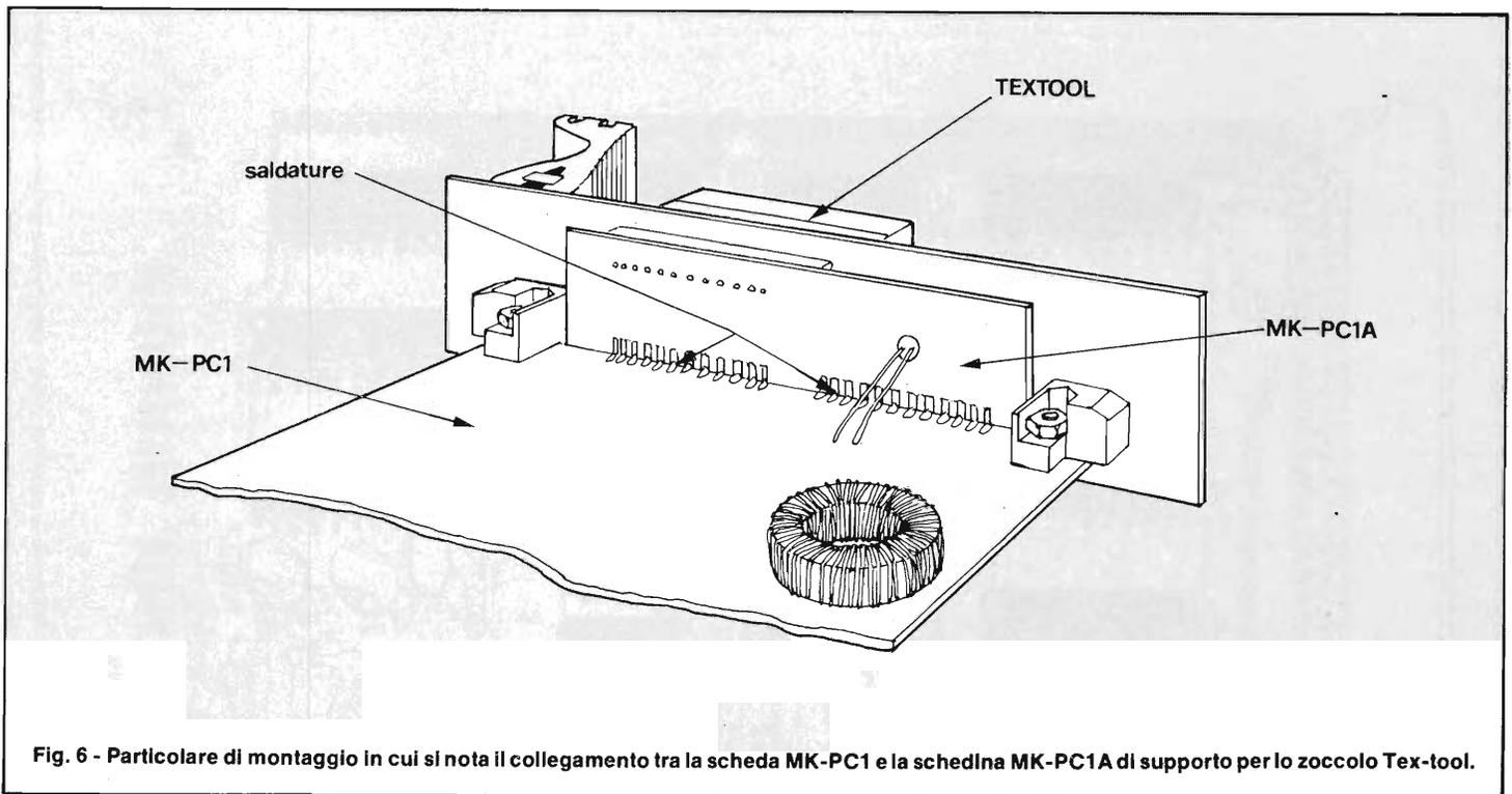
Fig. 6 - Particolare di montaggio in cui si nota il collegamento tra la scheda MK-PC1 e la scheda MK-PC1A di supporto per lo zoccolo Tex-tool.
