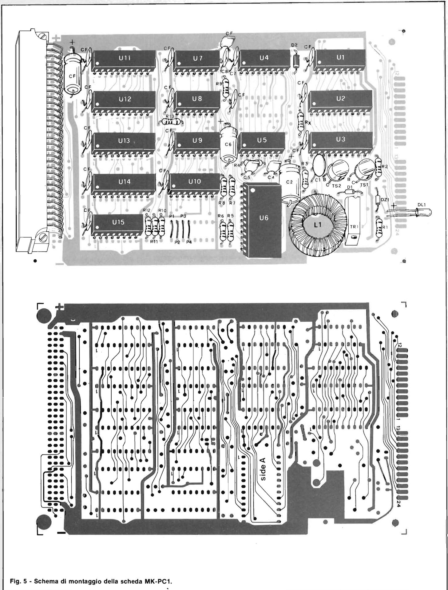
Fig. 5 - Schema di montaggio della scheda MK-PC1.
