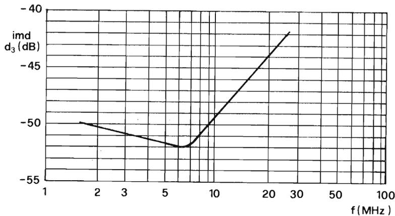
Fig. 13 - Grafico relativo al livello di distorsione.
