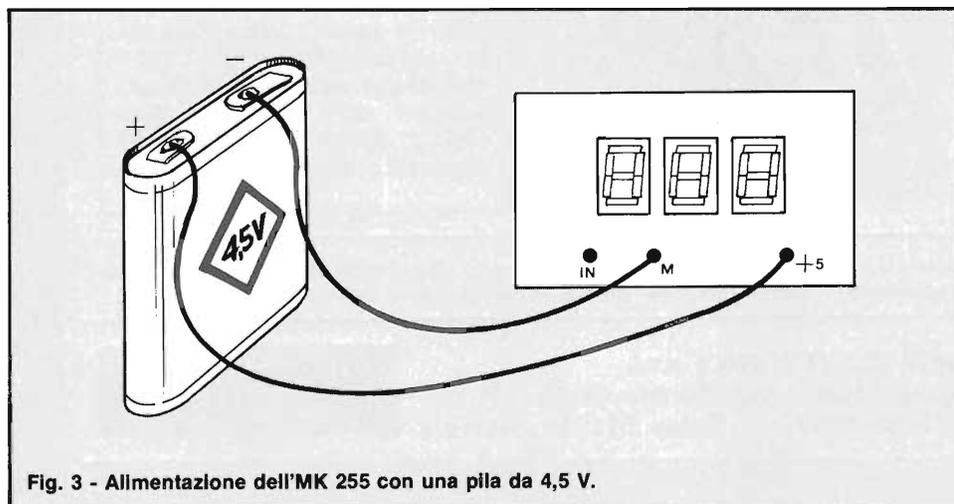
Fig. 3 - Alimentazione dell'MK 255 con una pila da 4,5 V.
