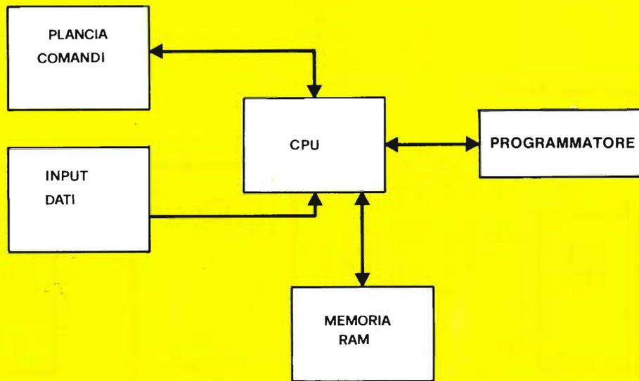
Fig. 1 - Schema a blocchi funzionale di un prom-programmer computerizzato.
