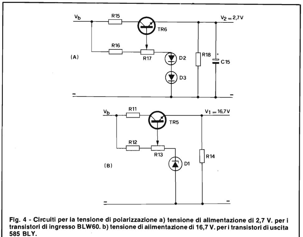
Fig. 4 - Circuiti per la tensione di polarizzazione a) tensione di alimentazione di 2,7 V. per i transistori di ingresso BLW60. b) tensione di alimentazione di 16,7 V. per i transistori di uscita 585 BLY.
