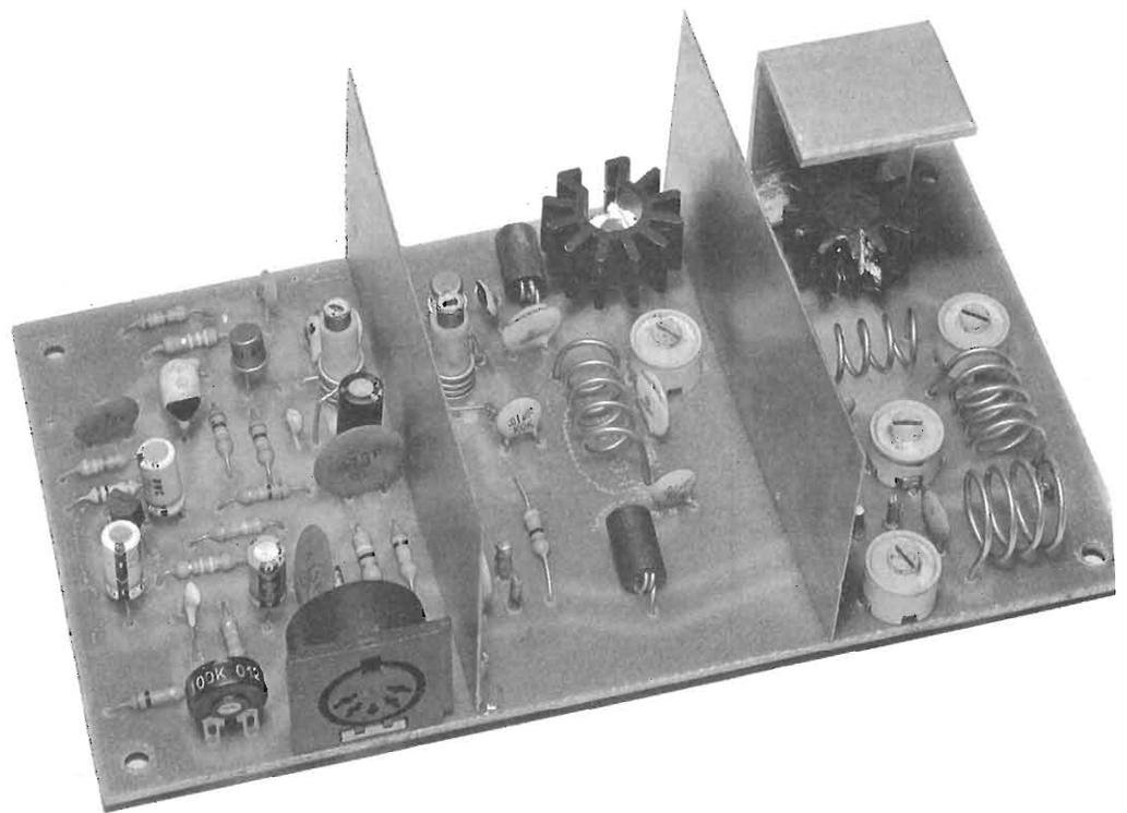
Stadio finale di uscita del trasmettitore FM KS 195. I vari settori vengono separati da schermi metallici.
