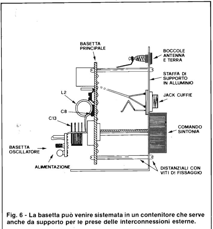
Fig. 6 - La bassetta può venire sistemata in un contenitore che serve anche da supporto per le prese delle interconnessioni esterne.
