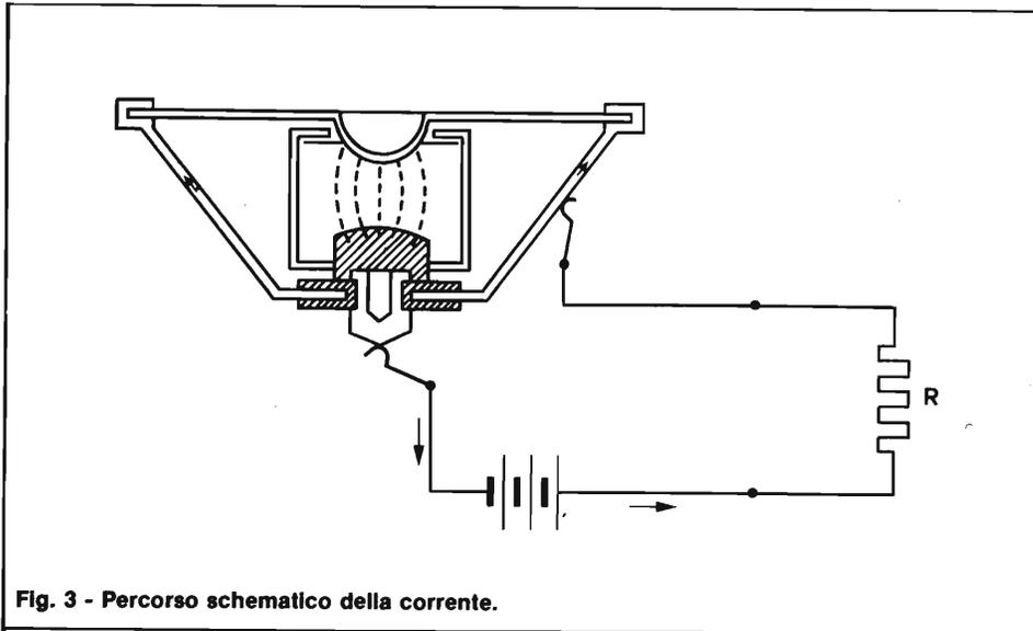
Fig. 3 - Percorso schematico della corrente.
