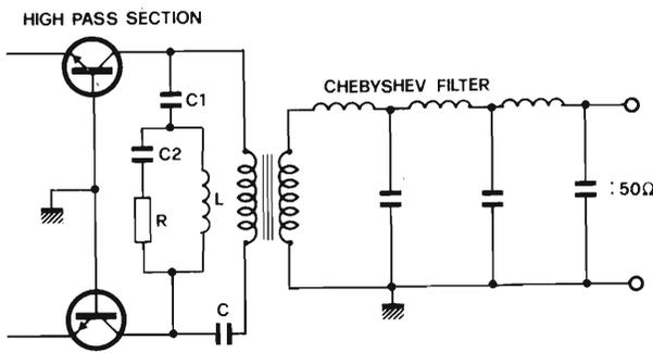
Fig. 5 - Filtri passa-alto e filtro Chebyshev di uscita.
