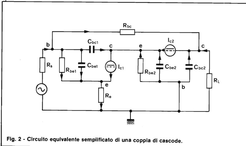
Fig. 2 - Circuito equivalente semplificato di una coppia di cascode.
