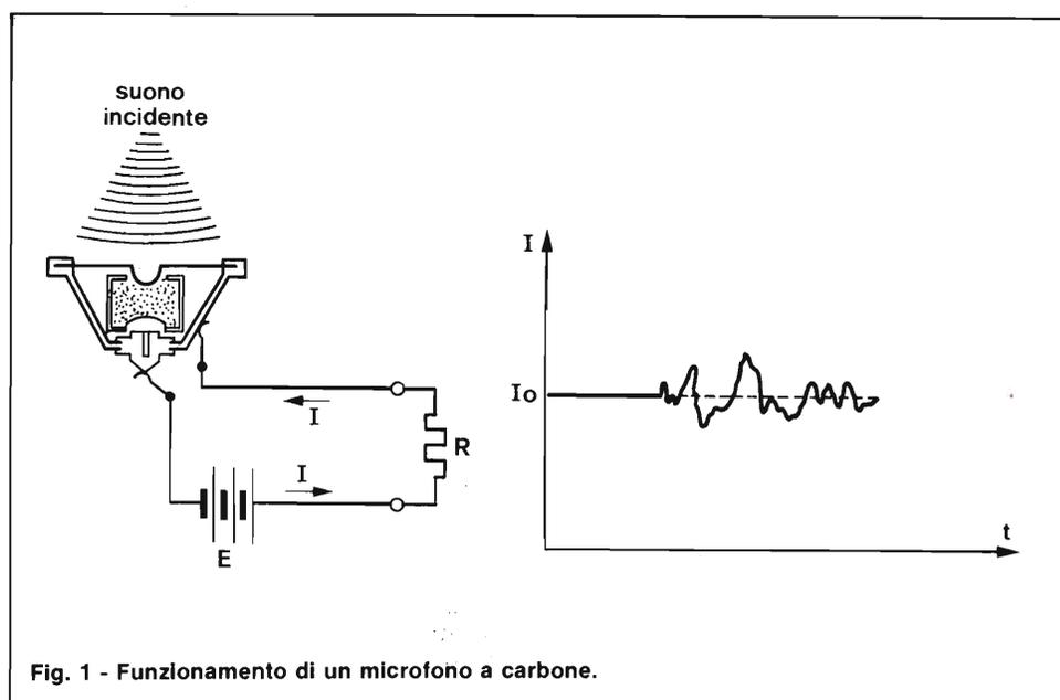
Fig. 1 - Funzionamento di un microfono a carbone.
