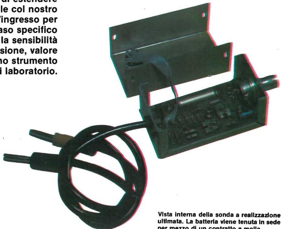
**Vista interna della sonda a realizzazione ultimata. La batteria viene tenuta in sede per mezzo di un contratto a molla.**
