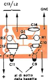
Fig. 5 - Disposizione dei pochi componenti sulla basettina dell'oscillatore che verrà poi saldata direttamente ai reofori del C13.
