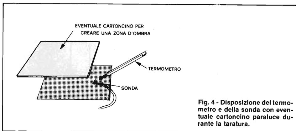
**Fig. 4 - Disposizione del termometro e della sonda con eventuale cartoncino paraluce durante la taratura.**
