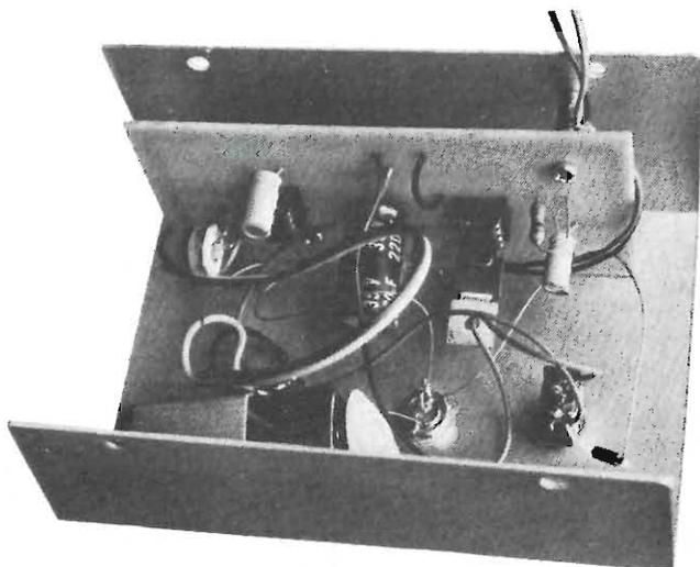
Fig. 3 - Prototipo dell'attivatore per flash raccolto in una scatola metallica. La pila si scorge in primo piano. Tutte le altre parti impiegano come supporto un circuito stampato montato verticalmente. Non si tratta di una disposizione obbligatoria, ed anzi il montaggio non è affatto critico.
