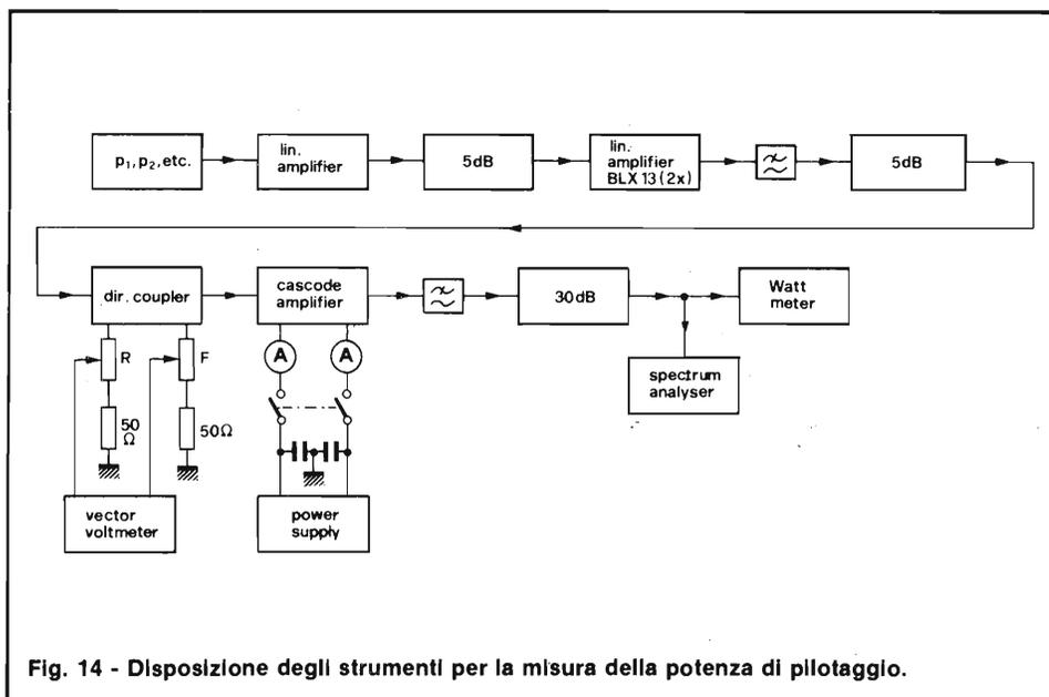
Fig. 14 - Disposizione degli strumenti per la misura della potenza di pilotaggio.
